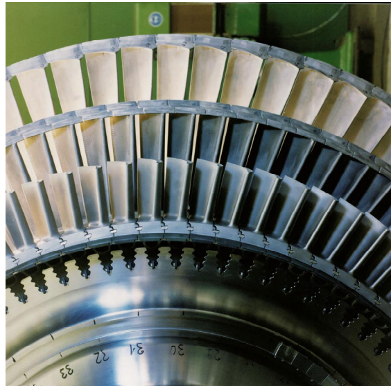
Bild 1: Fügestelle Schaufel/Scheibe einer Gasturbine (Quelle: ALSTOM Power AG)
