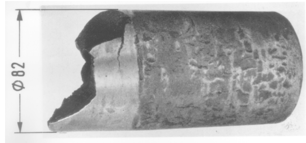
Bild 2: Bruch einer Welle, unterstützt durch Fretting
