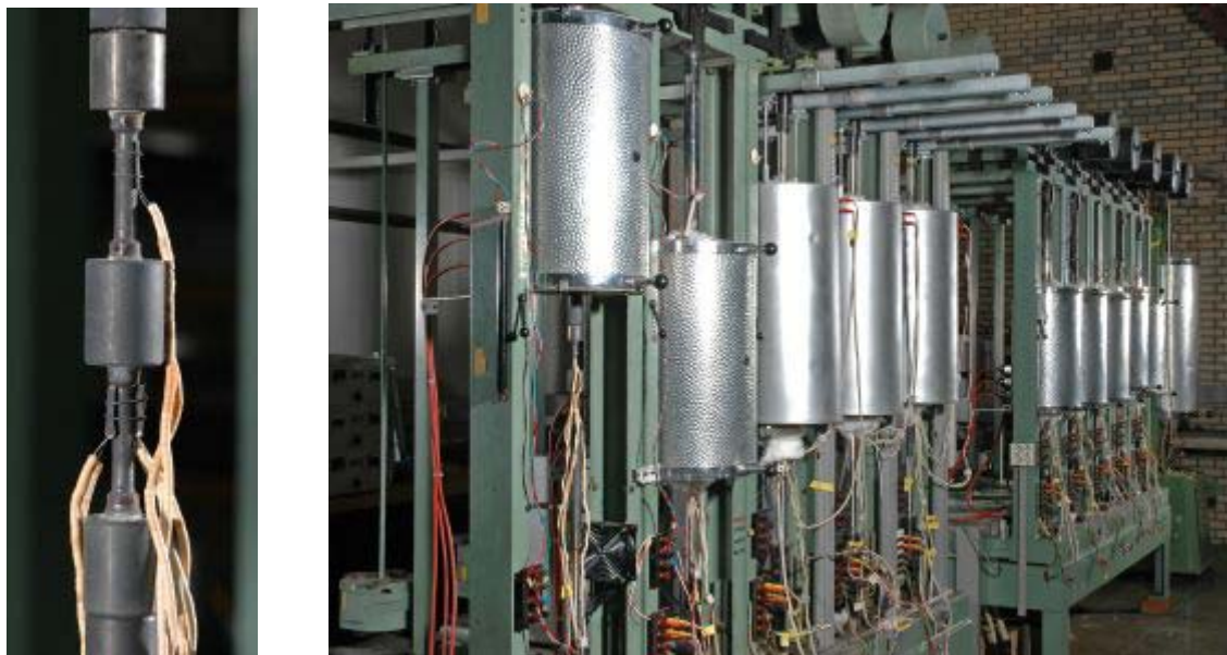
Ermittlung von Zeitstandwerten für warmfeste Werkstoffe im Rahmen von Werkstoffeinzelgutachten (DGRL Anhang 1 Abschnitt 4.2b und c) bzw. Europäischen Werkstoffzulassungen (DGRL Artikel 11)
