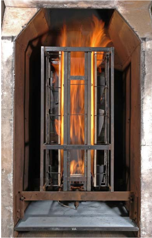
Brandschacht nach DIN 4102-15: Beflammung der vier schachtartig angeordneten Proben mit einem quadratischen Gasbrenner
