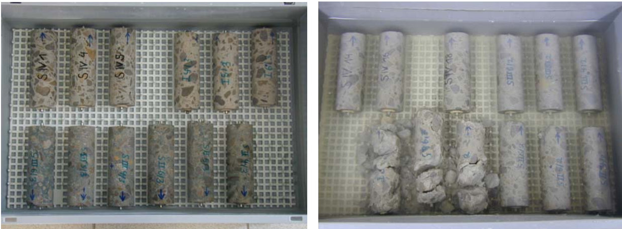
Fig. 5: Bohrkern zu Beginn der Einlagerungsversuche (links) und zerstörte Betonbohrkerne S I nach Ablauf einer Lagerungsdauer von 150 Tagen
