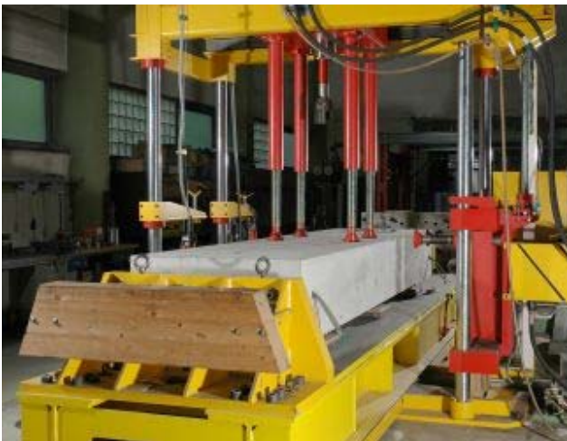
Prüfung von Befestigungselementen unter mehr-axialer Beanspruchung im gerissenen Beton
