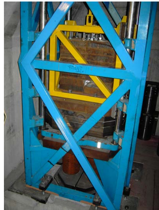
Testkammer im Fundamentbereich mit Fallmasse
