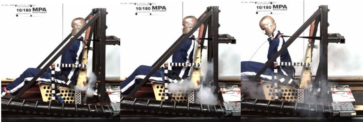
Erwachsenensicherheitsgurt mit pyrotechnischem Gurtstraffer beim Crashversuch
