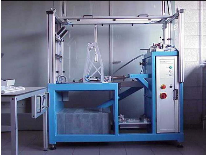
Beschleunigungsschlitten für Sicherheitsgurtbandaufroller
