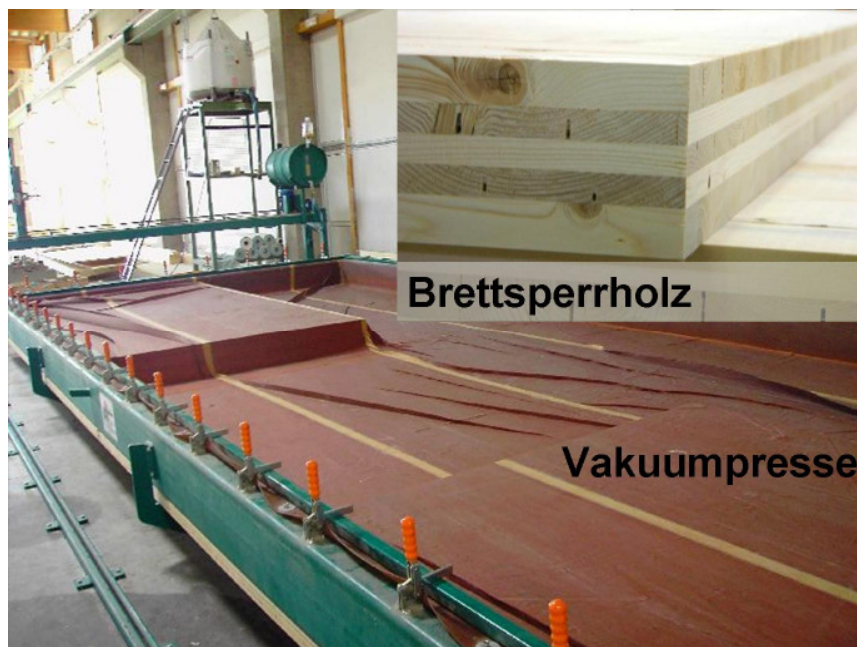
Abb. 2: Herstellung des verklebten Vollholz-Werkstoffes Brettsperrholz in einer Vakuumpresse
