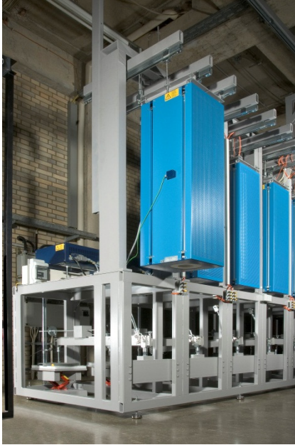
Abb.7: Neue Zeitstandprüfsysteme und Messeinrichtung zur laufenden Dehnungsmessung
