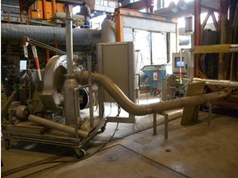
Bild 3: Ansicht der Prüfeinrichtung (Ventilator und Messstrecke) während eines Brandversuchs
