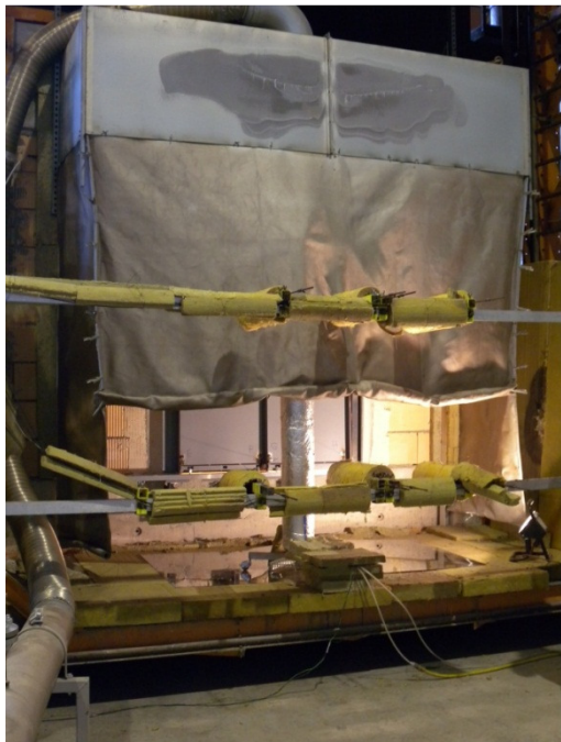
Bild 2: Ansicht einer Fahrschachttür (Schwellenbereich) mit montiertem Baldachin vor dem Brandversuch. Die Tür ist durch die Schürze des Baldachins teilweise verdeckt. Links ist noch ein Teil des Mess-Systems (Rohrleitung und Messstrecke) zu erkennen
