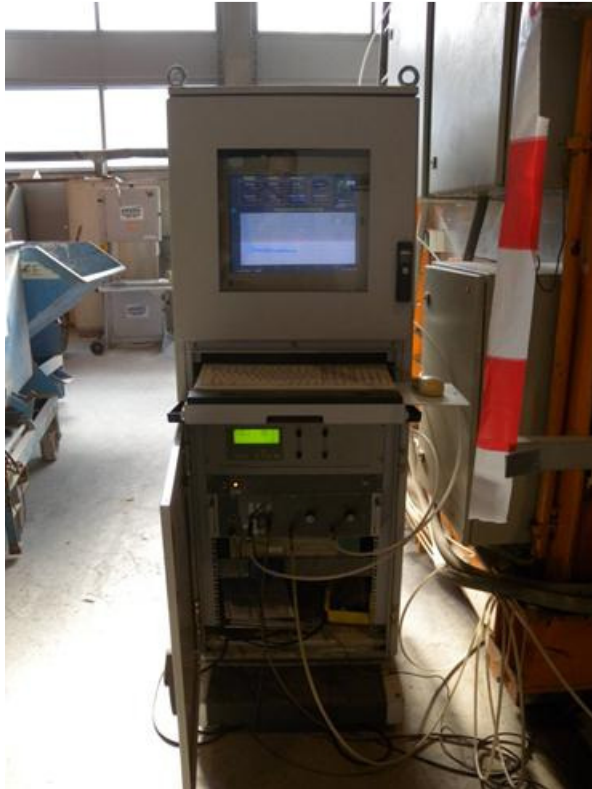
Bild 5: Ansicht des mobilen Mess-Schranks zur Messdatenerfassung und -auswertung
