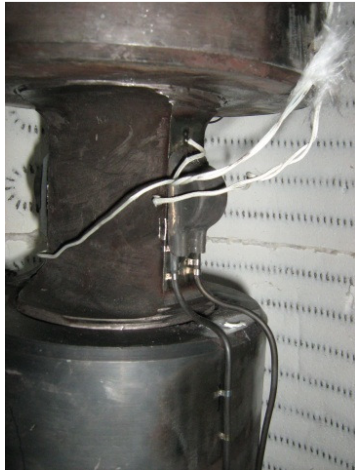
Abb. 9: Kapazitiver Hochtemperatur-Dehnungsaufnehmer zur Messung der Rissöffnungsverschiebung an großen Bruchmechanikproben
