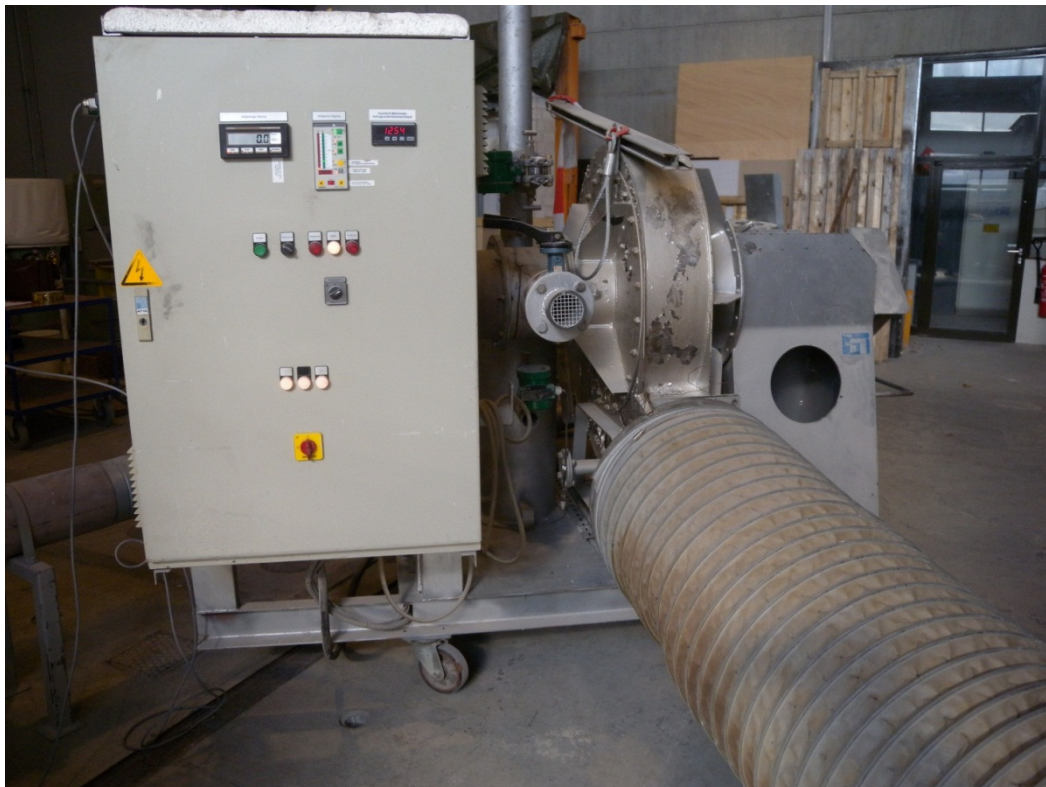
Bild 6: Ansicht des Ventilator-Systems zur Erzeugung des Volumenstroms
