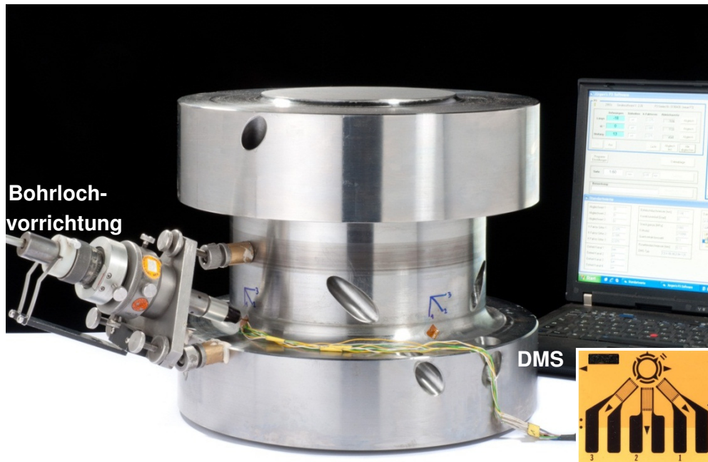
Abb. 11: Vorrichtung für die Bohrlochmethode und spezieller Dehnungsmessstreifen (DMS): Einsatz an mechanisch verfestigter Kerbstelle
