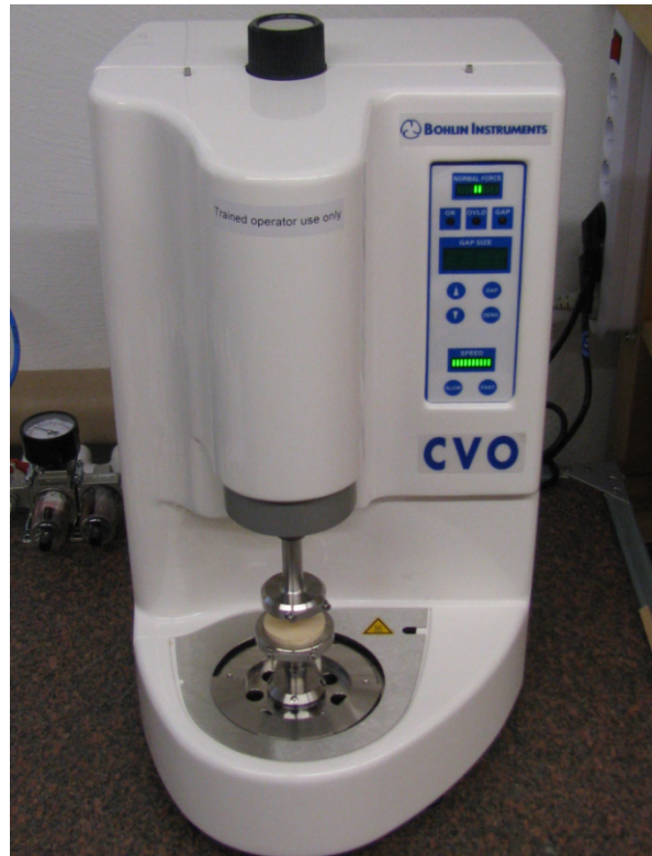
Abb.:2: Ansicht des Plattenrheometers mit eingebauten Holzplatten
