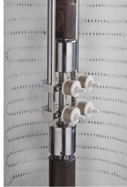
Abb.7: Neue Zeitstandprüfsysteme und Messeinrichtung zur laufenden Dehnungsmessung
